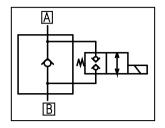
本バルブはLVSH-2シリーズのシャットオフバルブのポート面に積層して使用します。 AポートからBポートへの方向の圧油は通過させ、逆方向の流れは阻止します。
